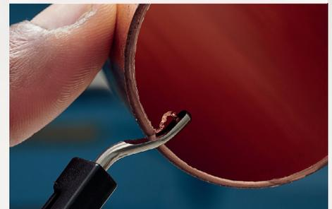
Der präzise geschliffene Entgrater lässt sich bei Bedarf entnehmen.
