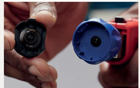
Für den schnellen Wechsel befindet sich ein Ersatzschneidrad im blauen Drehknopf.
