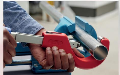
Mit einem Griff lässt sich der TubiX® XL an alle Rohrdurchmesser zwischen 6 und 76 mm schnell und präzise ansetzen.
