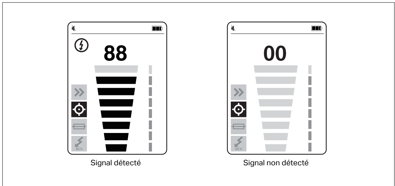
Figure 10. Puissance du signal du capteur de la pointe (2052R)
