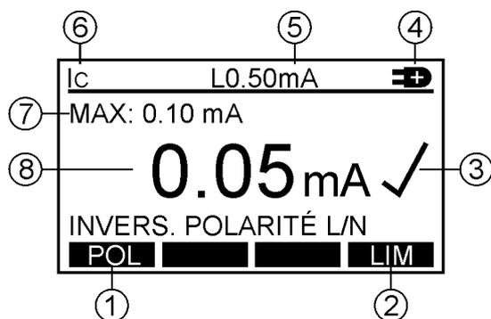
Figure 24: Affichage en mode test du courant de fuite de contact Ic (exemple)
