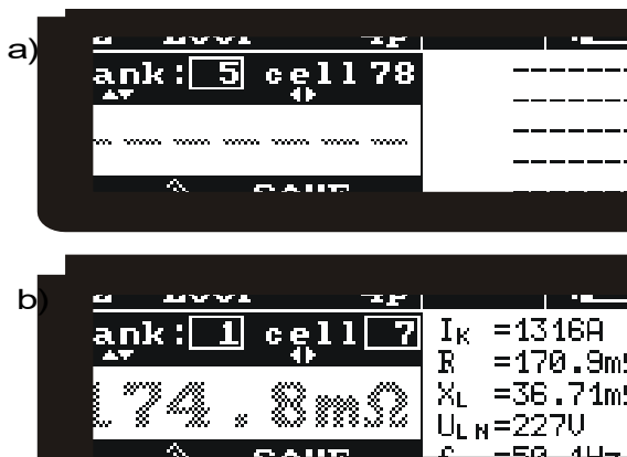
Fig. 27 Vue de l'écran en mode de saisie en mémoire: a) cellule vide b) cellule avec résultat enregistré (résultat principal affiché en gris)
