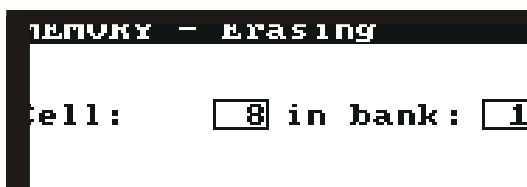
Fig. 29 Suppression d'une cellule en mémoire: 1 – No de banque, 8 – No de cellule, – banque avec au moins une cellule occupée, – cellule occupée
