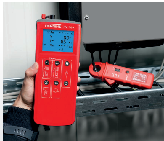
DC-Betriebsstrommessung mit BENNING CC 3
