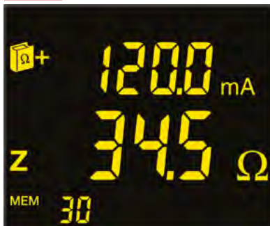
1. Anzeige: Impedanz und Fehlerstrom
