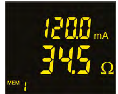
Standardmodus: Impedanz und Fehlerstrom
